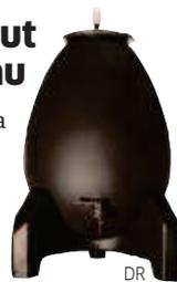
inventée à Puidoux après deux années de développement pour les vigneronnes. Cet œuf sur socle contient 585 litres de liquide. Il permet par exemple le décuveage par simple renversement évitant la pompe mécanique. Surtout, à vide, la cuve pèse 40 kg contre 1300kg pour son homologe en béton. Plus sur [www.ovoide.ch](http://www.ovoide.ch) Ir
